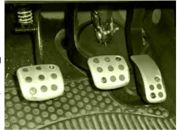
Estas funciones se consiguen con los pedales de acelerador, freno y embrague dispuestos por debajo del panel de mandos.
