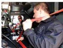
Se trata de una cinta cruzada que sujeta simultáneamente tórax y abdomen, de forma que reduce drásticamente el riesgo de deslizamiento o desplazamiento frontal del cuerpo en caso de colisión.
