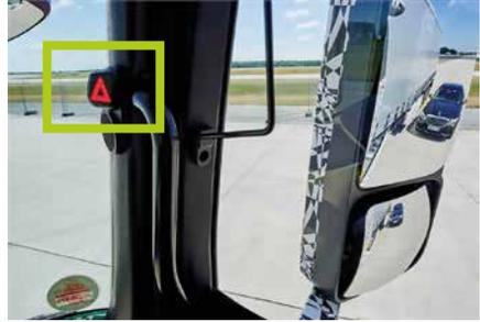
Concretamente, el sistema avisa al conductor mediante un led amarillo en forma de triángulo colocado sobre el montaje vertical de la puerta derecha. Si existe peligro de atropello esta luz se vuelve roja y aumenta de brillo e intensidad a la vez que suena un pitido, de forma que el conductor queda advertido del peligro potencial de atropello o arrollamiento.
