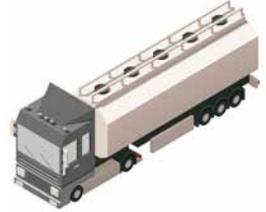
Cuando esto sucede, el centro de gravedad del vehículo también se desplaza, incrementando la posibilidad de vuelco. Además, si este desplazamiento de carga tiene lugar en la misma dirección de avance (lo cual tiene lugar en incluso en tramos rectos cuando se frena o se acelera enérgicamente), se pueden llegar a producir cambios repentinos en la velocidad de avance, alterando la estabilidad y la seguridad del vehículo.
