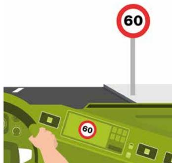
Otra variante más sencilla de este dispositivo es el regulador de velocidad, en el cual el conductor debe introducir en el sistema la velocidad máxima a la que desea circular. De este modo, cuando el conductor acelere el vehículo intentando rebasar el límite preestablecido, el sistema actuará limitando la potencia o frenando el
