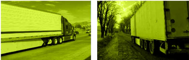
En cualquier caso, para evitar que la barra anti-empotramiento ceda, se estima que esta barra debe situarse a 45 centímetros del suelo, de forma que el automóvil pueda liberar parte de la energía mediante la deformación de su estructura.
